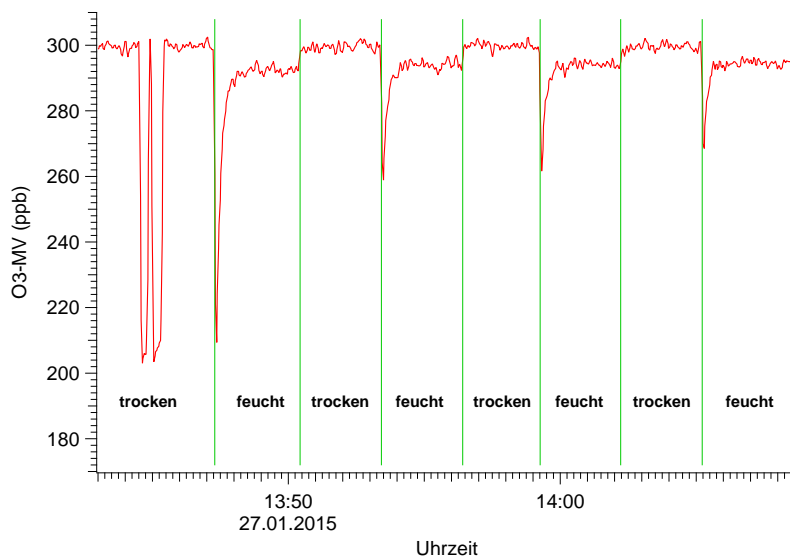
Abbildung A.3.: Umschalttest zwischen trockener und Wasser überströmender Luft. Dabei sind die einzelnen Bereiche entsprechend markiert.
